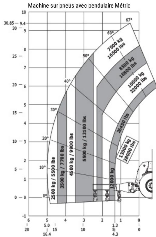
Machine sur pneus avec nacelle Métric
